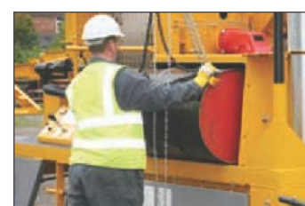
Барабан загрузки битума (оборудован порталным краном)
